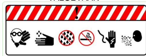
BESCHERMINGSMIDDELEN NODIG/BIJTENDE STOFFEN/NIET SCHOONMAKEN MET GERICHTE STRAAL/NIET ROKEN/GEVAAR VOOR ELEKTRISCHE SCHOK/EXPLOESIE GEVAAR
